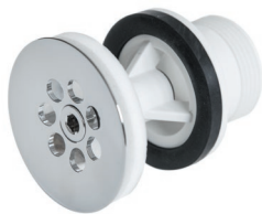
Silventil Överdel i förkromad mässing, underdel i plast. Utv R32.
