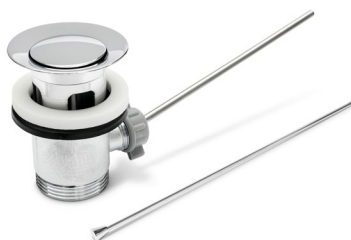
Lyftventil Över- och underdel samt lyftstång i förkromad mässing. Utv. R32.
